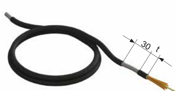
Figure 25 Dénuder le câble CEM sur 30 mm avant le branchement sur le bornier. La cote « t » correspond à la distance approximative du collier de fixation à la borne.
